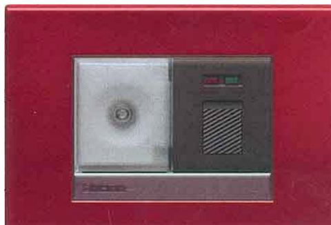
Placa amaranto (3 módulos). Lámpara de emergencia extraíble. Enciende automáticamente ante una falta en el suministro eléctrico. Dos horas de iluminación independiente.
