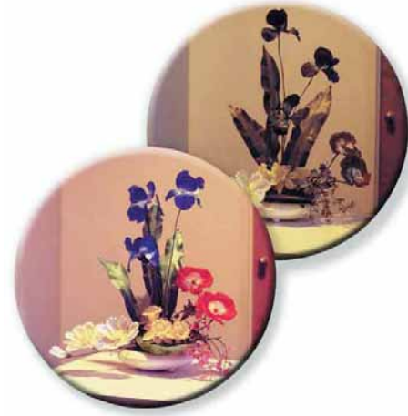
En estas fotografías se aprecia la diferencia de 2 objetos idénticos iluminados con diferentes fuentes de luz, con la misma temperatura de color pero diferente CRI.
